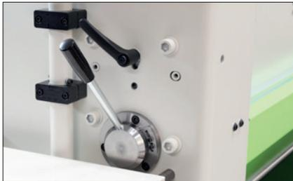
Einfache und deutliche Schnittspalteinrichtung für unterschiedliche Blechstärken.
