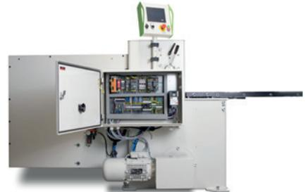
Benutzerfreundlich mit einfachem Zugriff auf Steuerung, Schaltschrank, Elektronik und Hydraulik.
